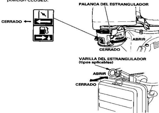
Para arrancar el motor cuando está caliente, deje la palanca del estrangulador o la varilla del estrangulador en la posición OPEN.
